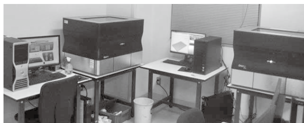
図2 当校の所有する3Dプリンタ (Stratasys社製 Objet30 およびObjet30Pro)
