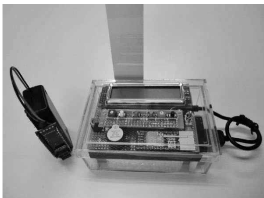
図3 無線を使ったスタートゲート付き計時装置
