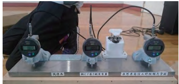
図1 鉋くず厚さ測定装置の試作品
