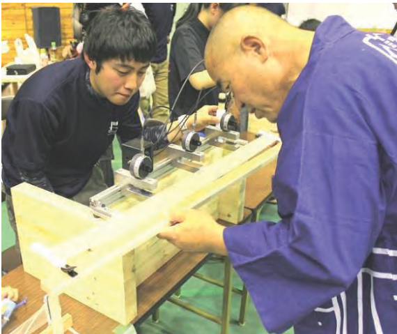
図10 鉋くずの厚さを計測する職人の様子
