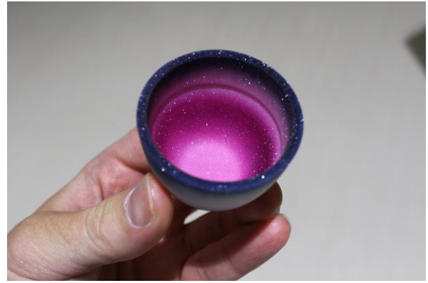
図2 ルビー結晶を育成したアルミナ製のつぼ
