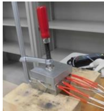
図4 経木をヒートプレスしている様子
