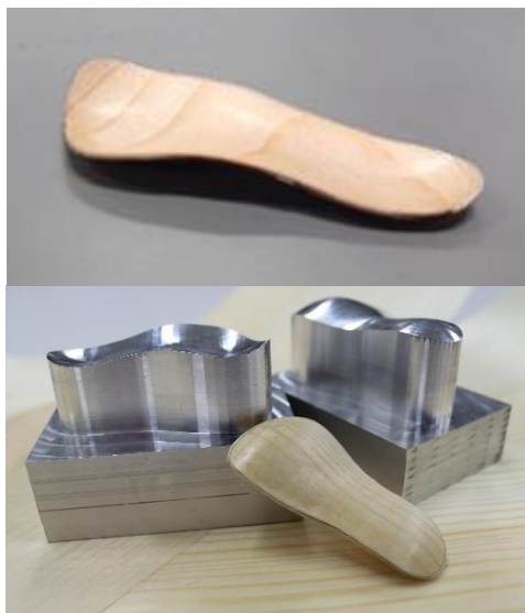
図6 弥生ヶ丘高校の生徒が作った 経木のミニチュアサンダル（上） 金型とミニチュアサンダル（下）
