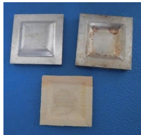
図5 弥生ケ丘高校の生徒が作った経木のお皿 上の2枚は金型、下の1枚が完成したお皿
