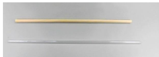
図3 経木を寒天で接着して作ったストロー(下は製作用のガラス棒)
