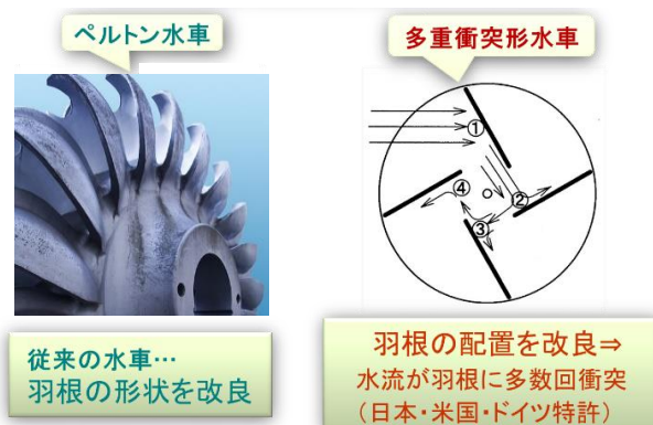
図1 多重衝突形水車の効率向上の考え方
