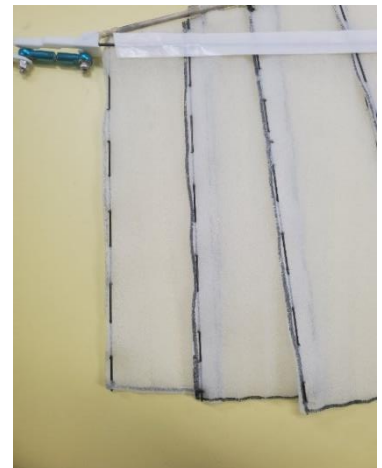
図3 翼に使用したカーボンロッド
